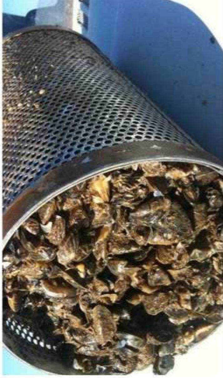
*Aspecto de una tubería completamente llena y colapsada por el mejillón cebra adherido. (DN.)*
